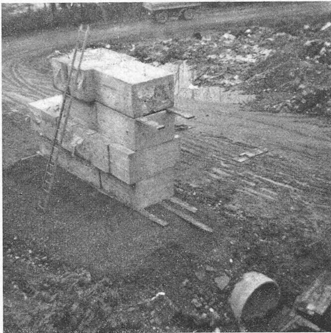
Bild 8. Feldversuch, Dauerbelastung 3 Tage
