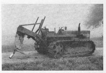
Bild 4 (oben). Grabenfräse «Hoes-Gigant» beim automatischen Verlegen von «Plastac»-Kunststoffrohren aus PVC-hart. Gleichzeitiges Einbringen von Kies als Grabenfilter mit «Unimog 406» und angebautem Förderband [12]
