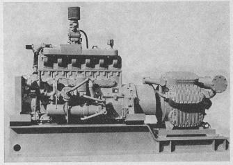
Wärmepumpe mit Gasmotor für höhere Temperaturbereiche. Gesamtleistung des Aggregates 650 kW bzw. 560 000 kcal/h (Sulzer-Escher Wyss-Pressephoto)
