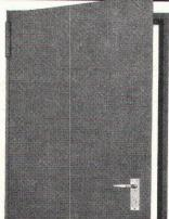
feuerhemmende Stahltüre F 30, 50 mm Mineralwolle-Isolation, Federbandtürschliesser, links und rechts verwendbar (einfach auf den Kopf stellen). Komplett mit Beschlag und Rahmen, in 4 Normgrössen
