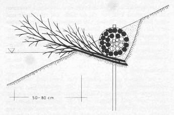
Bild 4. Ufer-Faschine, lebende und tote Weidenäste zusammengebunden und verpflockt, zum Schutz gegen Wellenschlag mit Buschlage (Schema)
