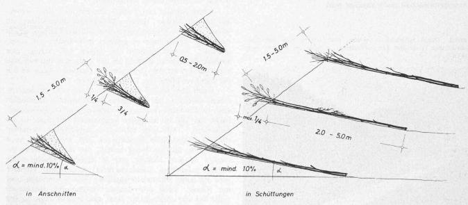
Bild 6. Bau von Heckenbuschlagen aus geschnittenen Weidenbüschen und adventiv bewurzelbaren starken Heistern (Schema)
