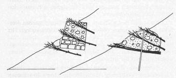
Bild 5. Begrünter Drahtschotterkörper, links aus verschweissten Stahlgittern, rechts aus elastischerem Drahtnetz, jeweils mit Buschlagen (Schema)
