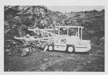
ist. Die Vorschublafette wird auf dem neuen elektrisch betriebenen Doppelausleger, dem Gardner-Denver-Mark-III-Jumbo, aufgebaut, der hohe Produktionsleistungen bei Tunnel- und Streckenvortriebsarbeiten gewährleistet.
