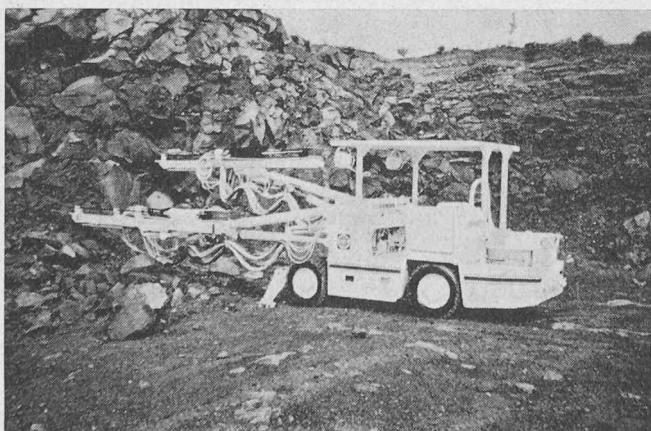
ist. Die Vorschublafette wird auf dem neuen elektrisch betriebenen Doppelausleger, dem Gardner-Denver-Mark-III-Jumbo, aufgebaut, der hohe Produktionsleistungen bei Tunnel- und Streckenvortriebsarbeiten gewährleistet.
