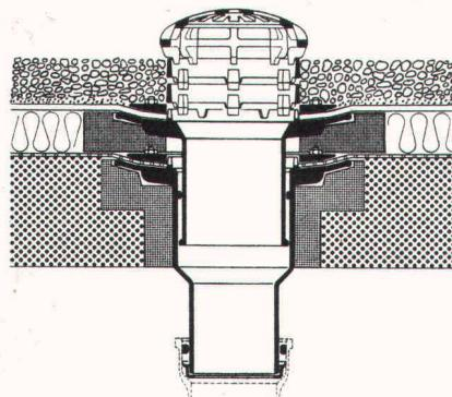
Flachdachablauf Guss zweiteilig, seitl. Auslauf 3° mit Kugelrost, Isolierring, Isolierkörper, Distanzringe 25 + 35 mm Höhe.
