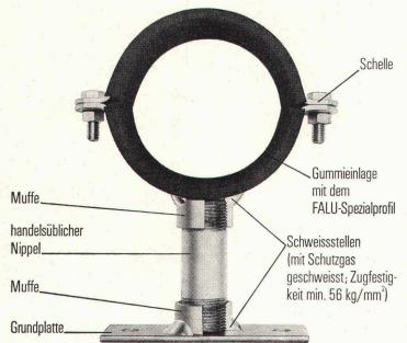
Dank dem Schutzgas-Schweissverfahren, bei dem wir Schweissmaterial von hoher Qualität und mindestens 56 kg/mm<sup>2</sup> Festigkeit an den Schweissstellen zuführen, können FALU-Rohrschellen einer hohen Belastbarkeit ausgesetzt werden.
