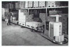
BARRETT-Elektro-Schlepper für manuelle Bedienung oder Funksteuerung oder fahrerlose elektromagnetische Steuerung
