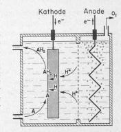
da der gesamte elektrolytische Wasserstoff auf die zu hydrierende Verbindung übertragen wird. Als weitere Vorteile können erwähnt werden:
