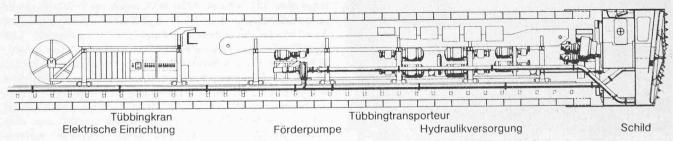
Bild 4. Einzelheiten des Maschinen- und Geräteeinsatzes beim Bentonitschild — eingesetzt beim Auffahren eines Abwasserkanals von 3,70 m Innendurchmesser und einschaligem Ausbau mit Stahlbetontübbings
