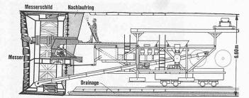
Bild 5. Messerschild mit Nachlaufring (Längsschnitt) für den Tunnelvortrieb in bindigen Böden beim Bau der Stadtbahn Frankfurt/Main, Los 20, sowie unmittelbar hinter dem Nachlaufring-Ausbau des Tunnels mit Spritzbeton
