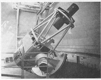
Weitwinkelaufnahme des ESO-Teleskopes in der Kuppel auf La Silla (Chile). Im Vordergrund rechts sieht man den Primärfokus-Käfig. Der 3,6-Meter-Spiegel im Zentrum ist nicht sichtbar. Links unten befindet sich der Cassegrain-Käfig für die Aufnahme von Zusatzinstrumenten
