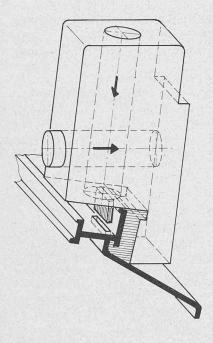
Profilführung und Lochstempel sind auswechselbar. Bei Bedarf kann das Werkzeug für unterschiedliche Profilabmessungen umgerüstet werden. Das Lochstanzwerkzeug LSW 16 wird auf dem Eckold-Handformer HF 80 CH eingesetzt. Dieses Handgerät ist leicht transportierbar (27 kg), es benötigt keinen Kraftanschluss und muss auch nicht fest montiert werden.
