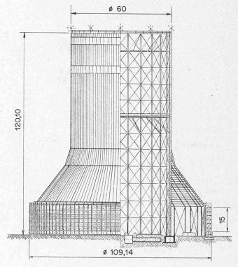
Bild 3. Ansicht, Querschnitt und Hauptabmessungen eines Stahlfachwerkturmes von Rasdan
