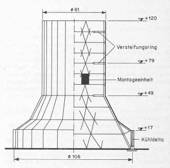
Bild 6. Neue Turmkonstruktion mit kegelstumpfförmiger Erweiterung und gemeinsamem Fundament mit den Kühldeltas
