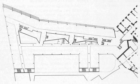
3. Obergeschoss, Schemagrundriss mit Büroflächen, rechts das bestehende Amtshaus
