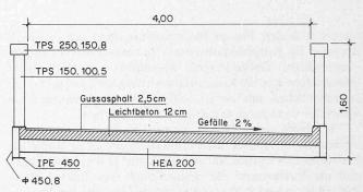
Bild 2. Fussgängerüberführung im Bild (St. Gallen)
