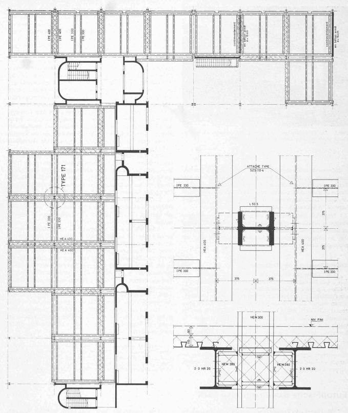
Bild 3 (links). Grundriss der Stahlkonstruktion mit massivem Treppenhaus und Liftkernen sowie einigen massiven Spezialräumen. Rastermass  $7.20 \times 7.20$  m
