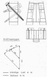
Bild links: Kabelverankerung im Feld (1:100). Bild Mitte: Pylonspitze (1:100).
