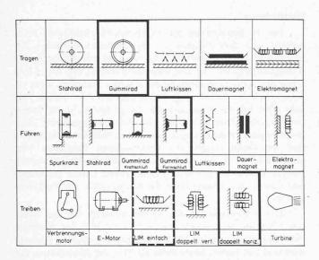
Bild 2. Morphologische Übersicht über Fahrwerksysteme
