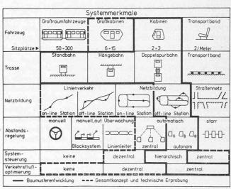
Bild 3. Morphologische Übersicht über spurgeführte Nahverkehrssysteme
