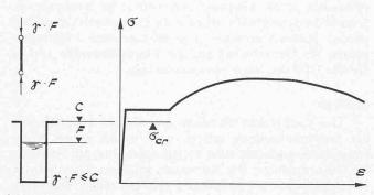
Bild 4. Tragkapazität, begrenzt durch Instabilität
