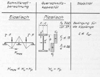
Bild 5 (links). Erste Möglichkeit für den TragfähigkeitsnachweisBild 6 (oben). Zweite Möglichkeit für den Tragfähigkeitsnachweis
