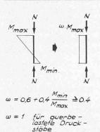
Bild 11. Anwendung des Modifikationsfaktors ω
