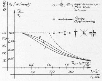
Bild 9. Europäische Knickspannungskurven
