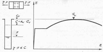
Bild 3. Tragkapazität, begrenzt durch Materialfestigkeit σ<sub>n</sub>
