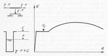
Bild 2. Tragkapazität, begrenzt durch die Materialfestigkeit  $\sigma_t$
