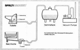
Spälti-Vacujet®, System Electrolux, saugt alle Abwasser mit Vakuum ab.
