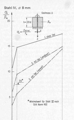
Bild 5. Gleitmassdiagramme für schwach profilierte Armierungsstähle (Stahl IV) mit walzfrischer bzw. öliger Oberfläche,  $\phi$  8 mm
