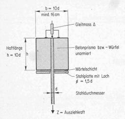
Bild 3. Versuchsanordnung
