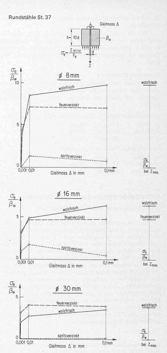
Bild 6. Gleitmassdiagramme für die Rundstähle  $\phi$  8, 16 und 30 mm. Schematische Darstellung der auf die Betonfestigkeit bezogenen Stahlspannungen in Funktion des auftretenden Schlupfes. Oberflächenbeschaffenheit: walzfrisch, feuerverzinkt und spritzverzinkt
