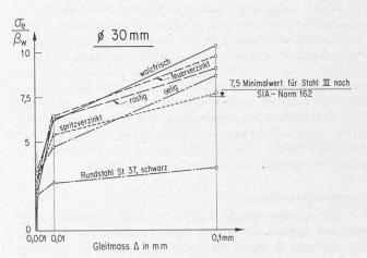
Bild 4. Gleitmassdiagramme für die Rippenstähle  $\phi$  8, 16 und 30 mm. Schematische Darstellung der auf die Betonfestigkeit bezogenen Stahlspannungen in Funktion des auftretenden Schlupfes. Oberflächenbeschaffenheit: walzfrisch, rostig, feuerverzinkt, spritzverzinkt, ölig. Zum Vergleich wurden die Diagramme der walzfrischen Rundstähle aufgetragen
