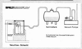
Spälti-Vacuflow fördert das Abwasser mittels Vakuum ohne Änderung der bestehenden Sanitärinstallationen!
