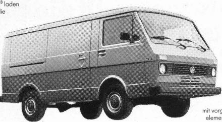
Zum Beispiel reguliert ein lastabhängiger Bremskraftregler die Bremskraftverteilung ie nach Nutzlast. Zum Beispiel garantieren ein Stabilisator vorn und ein Panhardstab hinten optimale Radführung und geringe Seitenneigung in den Kurven. Zum Beispiel ist seine Sicherheitstechnik mit vorgebauten Deformations-
