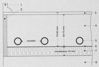
Multibetonsystem im Detail. 1 Fussleiste, 2 Randstreifen, 3 Bodenbelag, 4 Unterlagsboden, 5 Multibeton-Rohr, 6 Baufolie, 7 Wärmeisolation, 8 Betondecke
