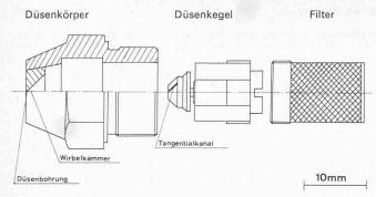
Bild 1. Bestandteile der Druckzerstäuberdüse
