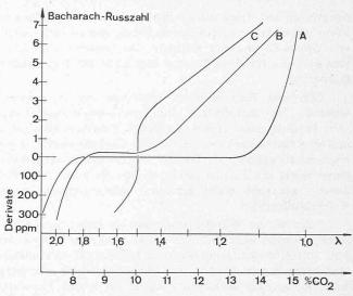
Bild 2. Die Russzahl bzw. der Gehalt an unverbrannten Ölderivaten dreier Ölfeuerungsanlagen in Funktion von  $\lambda$  bzw.  $CO_{2\rm gem}$
