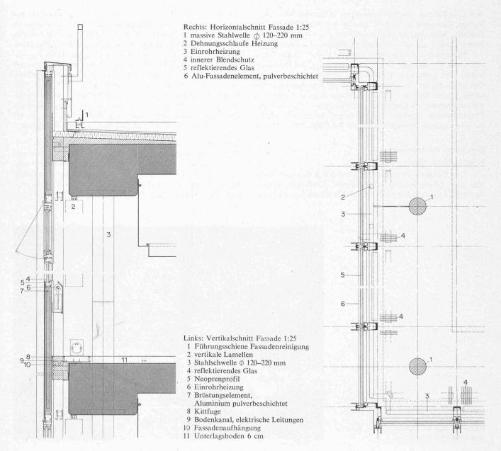
det. Für die Fassadenstützen wurden geschmiedete Stahlwellen mit Durchmessern von 120 mm bis 240 mm verwendet. Um möglichst schlanke Aussenstützen zu erhalten, wurden sie als Pendelstützen ausgebildet.
