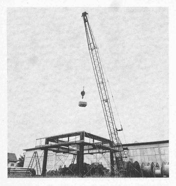
Bild 4. Versuchseinrichtung 1:1 mit Stahlgerüstrahmen, aufgespanntem Fangnetz und schwebendem Block
