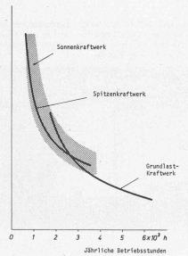
Bild 3. Verlauf der Energiekosten in Funktion der jährlichen Betriebsstunden
