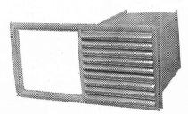
Diese speziell im Hin-blick auf Schallimmis-sionsprobleme entwik-kelte Typenreihe von Ansaugschalldämpfern verhindert das Austreten des Brenner-Kessel-Gedes Brenner-Kessel-Geräusches durch die Frischluftöffnungen des Heizraumes. Dämpfung 15 Dezibel durch Adsorption in geräumigen Kanälen — keine Filter-konstruktion, deshalb konstruktion, deshalb keine Verstopfungsgefahr.
