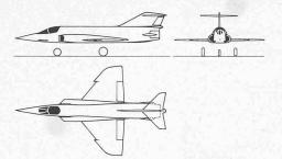
Bild 56. P-16 C/f bzw. P-17, Vorprojekt Dezember 1957. Massstab 1:400
