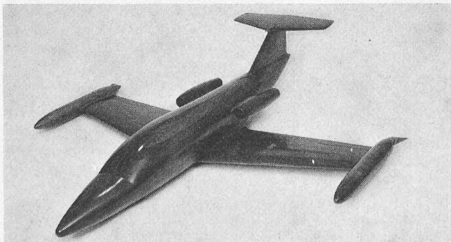
Bild 59. Modell des SAAC-23 (Learjet) für den Unterschall-Windkanal der ETH Zürich
