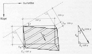
Bild 4. Verformungsdiagramm des Schubwandelements
