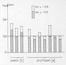
Bild 9. Grösste Schubrissweiten unter Gebrauchslast
