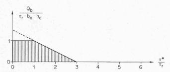
Bild 6. Zusätzlicher Schubwiderstand Qb
