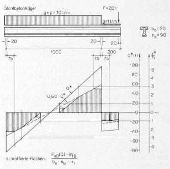
Bild 15. Beispiel Stahlbetonträger
