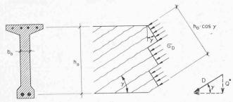
Bild 2. Beanspruchung der Betondruckdiagonalen
