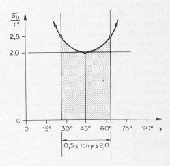
Bild 3. Druckspannung  $\sigma_D$  in Funktion von  $\gamma$
