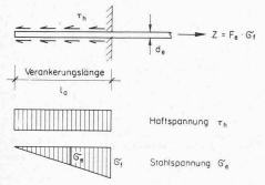
Bild 13. Verankerungslänge  $l_g$  aus Ausziehversuch
