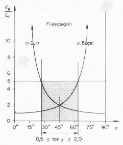
Bild 5. Begrenzung der Umlagerung  $\varepsilon_R$ : Nominelle Rissdehnung,  $\varepsilon_f$ : Stahldehnung bei Fliessbeginn
