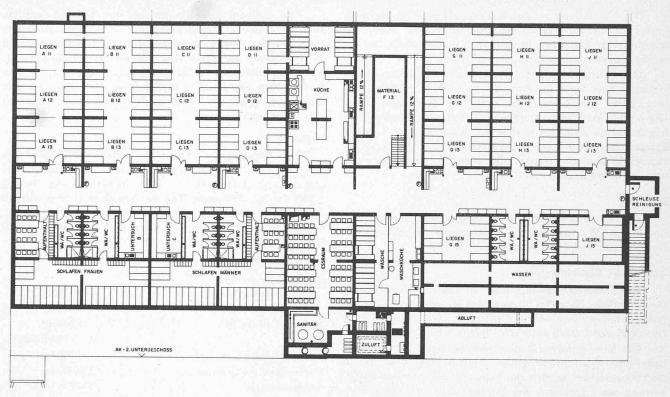
Oben: Grundriss Obergeschoss. Massstab 1:400
