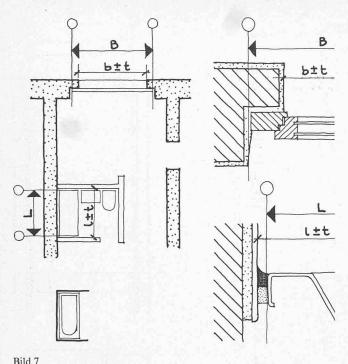
aus Gründen des Zusammenbaus grösser sein muss als seine Einbauöffnung, kann das Herstellungsmass der Loch-Einbau. öffnung kleiner werden als das zugehörige Koordinationsmass-
