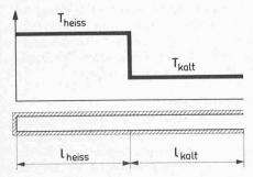
Bild 1. Schematische Darstellung der Temperaturverteilung entlang der Rohrwand
