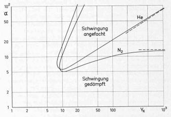
Bild 2. Stabilitätskurven für  $N_2$  und He. Gezeigt wird das kritische Temperaturverhältnis  $\alpha$  über dem dynamischen Ähnlichkeitsparameter  $Y_K$ . Anfachung erfolgt *innerhalb* der von den Kurven begrenzten Gebieten
