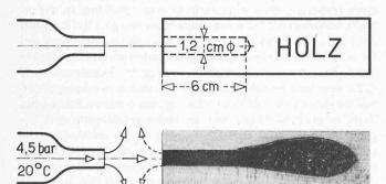
Bild 4. Durch thermische Wirkung im Hartmann-Sprenger-Rohr (gebildet durch eine Bohrung in einem Holzklotz) in 30 Sekunden erzeugte Brandkaverne (das Holzstück wurde längs der Bohrungsachse aufgesägt)
