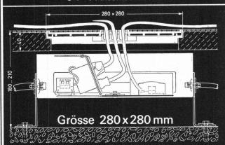
Rahmen in die Bodenplatte, Kasten auf dem darunter liegenden Boden auf höhenverstellbaren Füssen montiert 3 T+T Anschlussdosen
