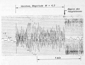
Bild 4. Rechts: Aufzeichnung des hochempfindlichen elektrodynamischen Seismographen der Station Basel
