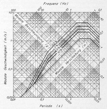
Bild 9. Repräsentatives Antwortspektrum im Epizentralgebiet für Lockergestein. Vertrauensintervall 75 %, modale Dämpfungen 2 %, 5 %, 10 %. Bemessungsspektrum nach Wash 1255
