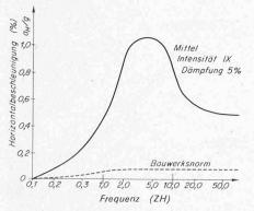
Bild 2. Verlauf der Horizontalbeschleunigung für Erdbeben der Intensität IX (MSK) nach [9]. Die gestrichelte Linie wiedergibt den in der konventionellen Erdbebennorm [2] zugrundegelegten Beschleunigungsverlauf
