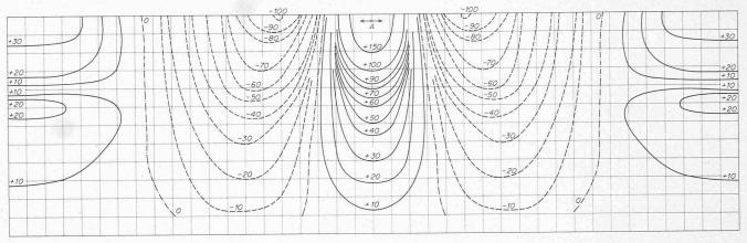
Bild 14. Modellmessungen an einer eingespannten Kreiszylinderschale. Momenteneinflussfläche im Punkt A am oberen Rand (δx in 1/100 mm)
