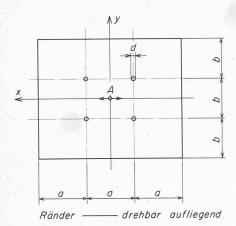
Bild 8. Pilzdecke mit vier Innenstützen Bild 9 (rechts). Pilzdecke, Modellversuch mit Plexiglasplatte
