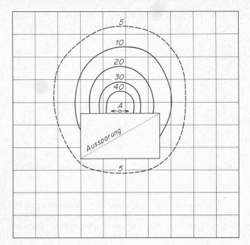
Bild 11. Quadratische Platte mit Aussparung
