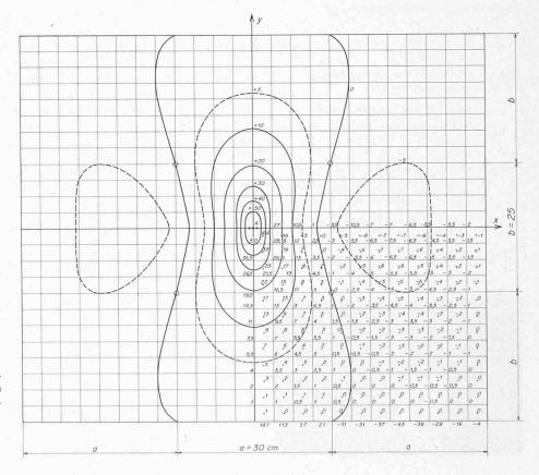
Bild 10. Modellmessungen.  $M_x$ -Einflussfläche für den Punkt A ( $\delta^x$ -Werte in 1/1000 mm). Ränder drehbar aufliegend.  $\alpha = 0.025$  (Anpresswinkel); Modellplatte d = 5 mm Plexiglas;  $\Sigma \delta^x = 4 \cdot 170 = 680/100$  mm = 6.8 m = 0.0068 m
