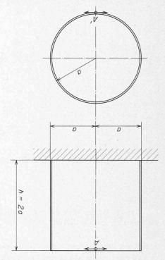
Bild 12. Eingespannte Kreiszylinderschale
