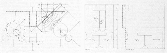
Detailplan einer Verkaufskoje. Die Elemente wurden vorfabriziert und steckerfertig montiert
