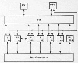
Bild 2. Ablaufsteuersystem mit zentraler DVA
