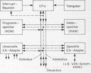
Bild 3. Prinzipielle Struktur eines Mikrocomputers
