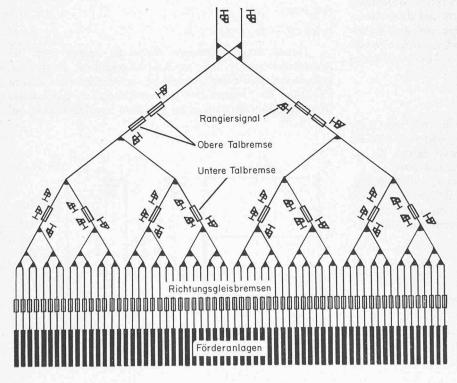
Bild 1. Gleistopographie einer Ablaufanlage mit 64 Richtungsgleisen
