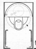
Aus vorfabrizierten Elementen kann die solide und mit allen Zubehören ausgestattete Kabine in wenigen Stunden anschlussfertig montiert werden. Keine zusätzlichen Kosten für Maurerarbeiten.
