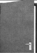
feuerhemmende Stahltüre F 30, 50 mm Mineralwolle-Isolation, Federbandtürschliesser, links und rechts verwendbar (einfach auf den Kopf stellen). Komplett mit Beschlag und Rahmen, in 4 Normgrössen
