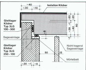
Diese elastisch gelagerte Decke ist mit **EFKAPRENE** (auf der Basis von Neoprene der **Feuchtigkeitsisolation** von **KILCHER** isoliert.
