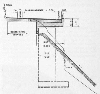
Bild 2. Typisches Querprofil innerhalb der Sanierungsstrecke
