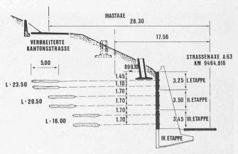
Bild 5. Sicherung des Eckmastes der 11-kV-Hochspannungsleitung
