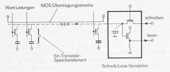
Schaltungsprinzip einer Zeile für den C³RAM mit Ein-Transistor-Speicherzellen als Grundbaustein
