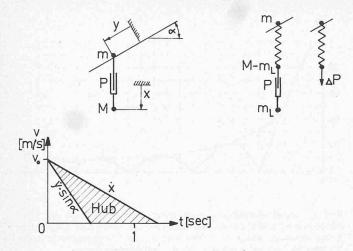
Bild 5 (links). Plastisches Modell eines Seilbahnfahrzeuges und *v-t*-Diagramm, welches die massgeblichen Geschwindigkeiten in Funktion der Zeit angibt. Die schraffierte Fläche entspricht dem Pufferhub
