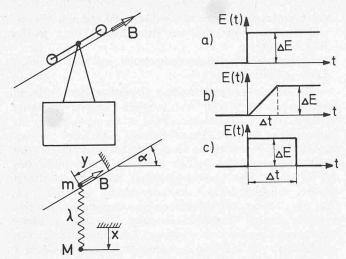
Bild 1 (links). Oben Seilbahnfahrzeug, unten elastisches Modell für die Untersuchung der Zugkraft in der Kabinenaufhängung
