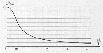
Bild 4. Höchste Amplitude der Schwingung bei einer Störfunktion mit konstant gehaltenem Antrieb S nach Bild 2c) gemäss Gleichung (3). Dies entspricht z. B. einer vorgegebenen Geschwindigkeitsänderung
