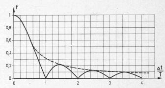
Bild 3. Amplitudenfaktor f nach einem Übergangsverlauf der Störfunktion gemäss Bild 2b) gemäss Gleichung (2). Wenn  $\Delta t/T$  ganzzahlige Werte annimmt, wird f = 0. Weil aber  $\Delta t$  und T meistens nicht exakt bestimmbar sind, ist es sicherer, mit der gestrichelten Kurve
