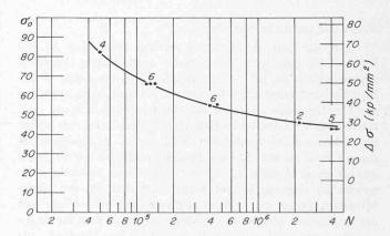
Bild 6. Ergebnisse der mit  $\sigma_u = 16.6 \text{ kp/mm}^2$  durchgeführten Schwellzugversuche (die Zahlen bei den Messpunkten geben die Anzahl der Versuchswiederholungen an). Die Grenze der Dauerfestigkeit (4 · 10<sup>6</sup> Lastwechsel) wurde bei einer Schwingbreite von 26,4 kp/mm<sup>2</sup> erreicht
