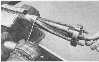
Bild 4. Nachdem der Innenkegel zwischen die Litzen geschoben und mit dem Kegelhalter fixiert wurde, werden die Litzen von aussen ebenfalls mit einem Aluminiumdraht umwickelt
