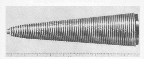
Bild 3. Innenkegel nach einem Schwellzugversuch mit gut sichtbaren Druckspuren der Litzen in der Aluminiumdraht-Umwicklung. Die örtlichen Flächenpressungen bleiben auf die Fliessgrenze des Umwicklungsmaterials begrenzt
