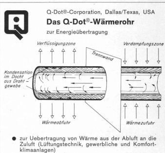
zur Rückgewinnung von Wärme aus Dämpfen und heissen Gasen, z. B. in der Zement-, Lebensmittelund Papierindustrie, Textilbetriebe, Trocknungsanlagen, Farbspritzkabinen und Giessereien
