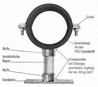
Dank dem Schutzgas-Schweissverfahren, bei dem wir Schweissmaterial von hoher Qualität und mindestens 56 kg/mm<sup>2</sup> Festigkeit an den Schweissstellen zuführen, können FALU-Rohrschellen einer hohen Belastbarkeit ausgesetzt werden.
